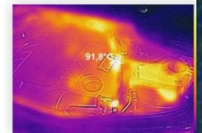
Ukázka teploty motorového prostoru za pomoci termovize
